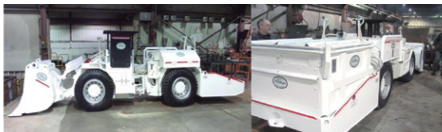
Figura 6. Vista de la batería So-Nick. Desmontado y montado en un LHD.
